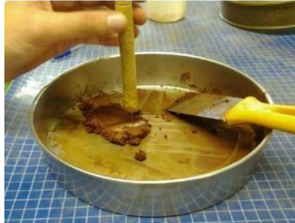
Figura 11. Teste de umidade de moldagem de pastilhas com minipenetrômetro (MATZEMBACHER, 2014)
