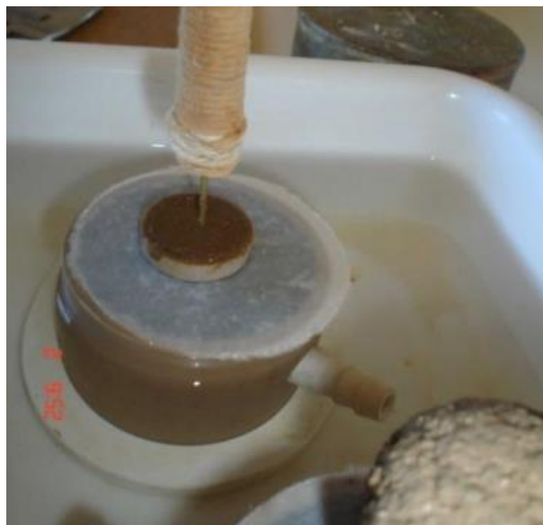
Figura 12. Penetração em pastilha saturada sobre pedra porosa (D'ÁVILA et al. , 2008)
