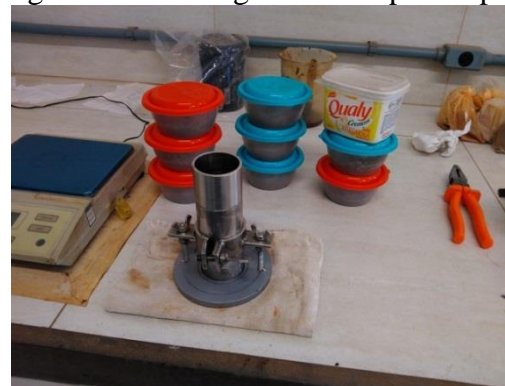
Fotografia 2. Moldagem dos corpos de prova
