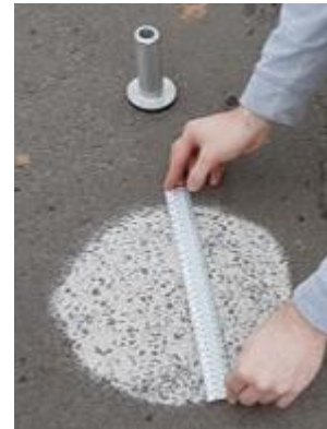
Figura 3. Ensaio mancha de areia
