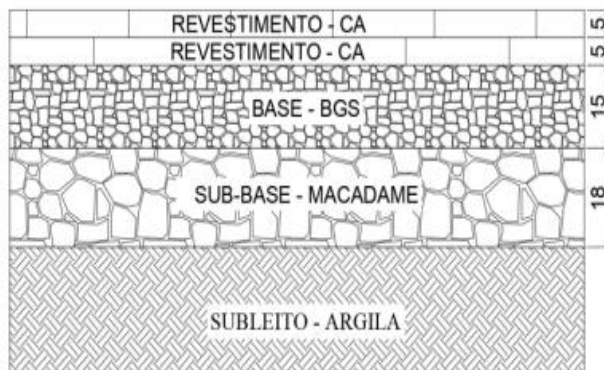
Figura 2. Estrutura do pavimento da ERS509- Faixa Velha
