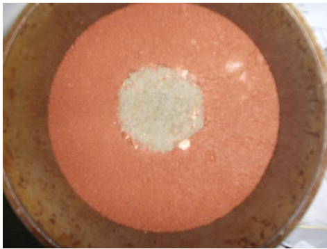
Figura 3. Resultado final das perfurações preenchidas em camadas por argamassa (BIONDO, 2007).
