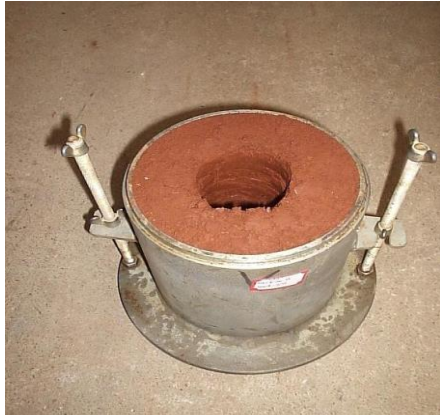
Figura 2. Modelo de ensaio perfurado com trado (BIONDO, 2007).
