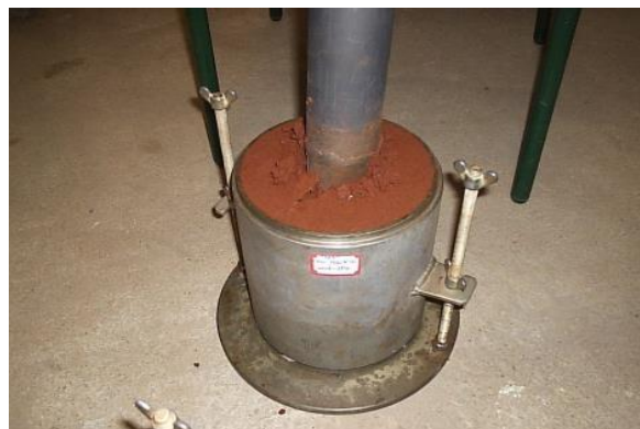
Figura 1. Processo de perfuração dos modelos de ensaio (BIONDO, 2007).
