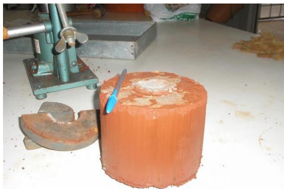
Figura 4. Detalhe da amostra após o rompimento da estaca (BIONDO, 2007).
