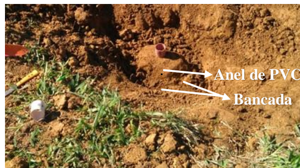
Figura 2. Coleta das amostras indeformadas em campo
