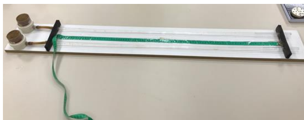
Figura 3. Equipamento utilizado no ensaio de infiltrabilidade
