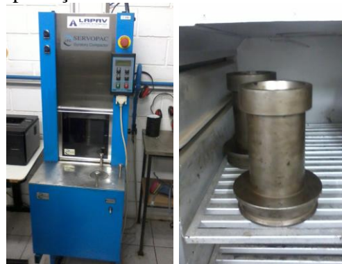
Figura 1. Compactador Giratório Superpave (esquerda) e moldes de compactação (direita)
