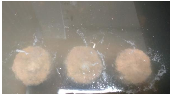
Figura 9. Corpos de prova de solo natural em imersão antes do ensaio de resistência à compressão simples mostrando dispersividade.
