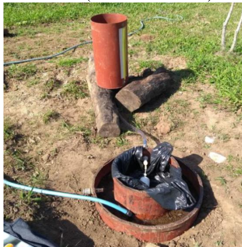
Figura 7 - Realização do ensaio de infiltração no solo (anéis concêntricos).
