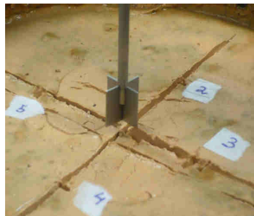
Figura 10. Detalhe da palheta preparada para cravação no solo adensado
