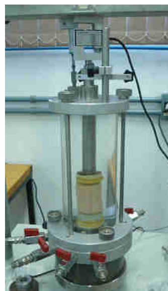
Figura 7. Corpo de prova na câmara triaxial
