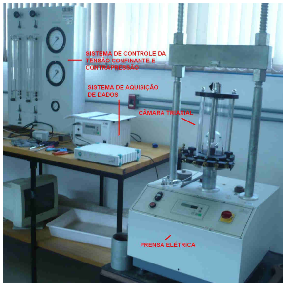
Figura 8. Arranjo experimental para os ensaios triaxiais
