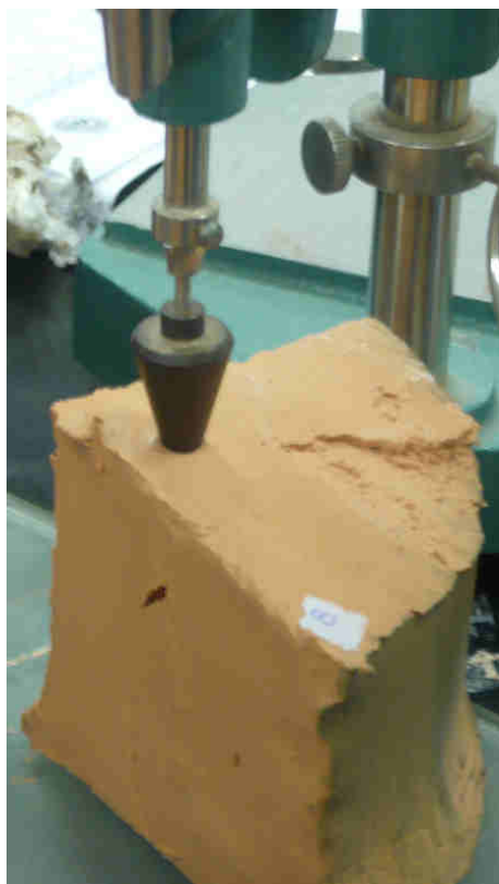
Figura 12. Detalhe do ensaio de cone em execução
