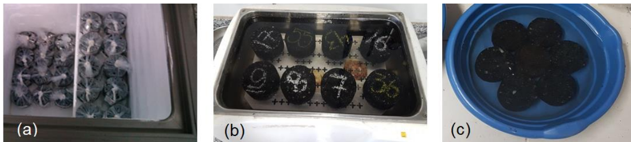
Figura 2 – Ciclos de congelamento e imersão em água. (a) Congelamento de 16 hrs à -18 °C. (b) Imersão por 24 hrs à 60 °C (c) Condicionamento por 2 hrs 25 °C
