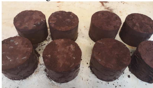
Figura 2. Ensaio de Compactação com Energia Intermediária
