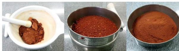
Figura 1: Execução do destorroamento de um solo.
