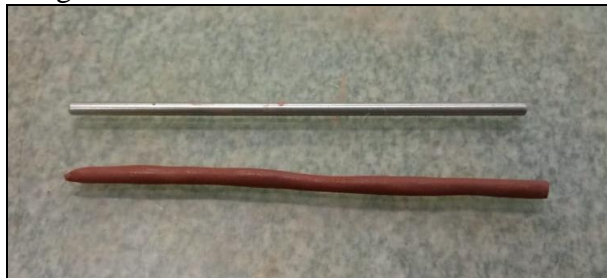
Figura 4: Ensaio de Limite de Plasticidade.
