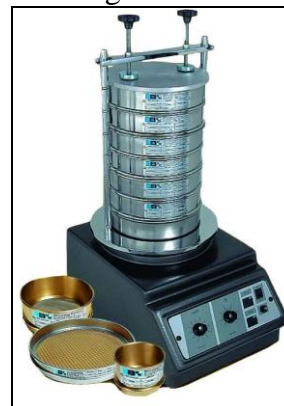
Figura 2: Conjunto de peneiras granulométricas e agitador.
