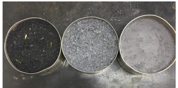
Figura 7. CCA in natura (esquerda), CCAT (meio) e CCATF (direita)
