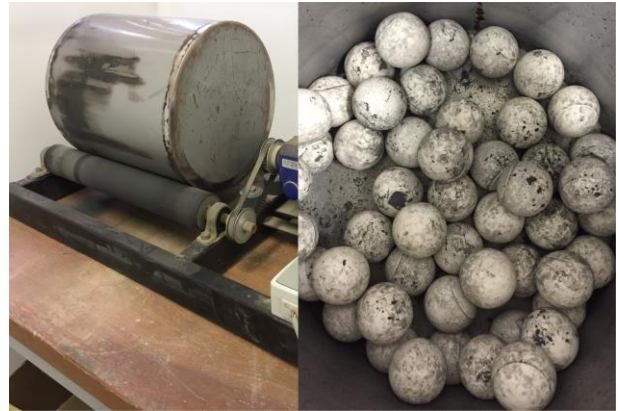
Figura 6. Moinho de bolas (esquerda) e corpos moedores (direita)
