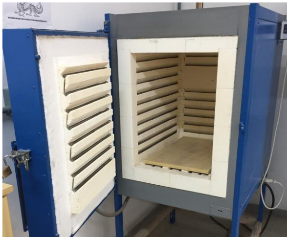
Figura 5. Forno elétrico tipo mufla
