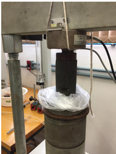
Figura 9. Execução do ensaio de RCS
