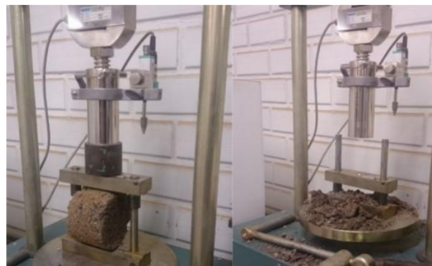
Figura 5. Ensaio de Tração por Compressão Diametral
