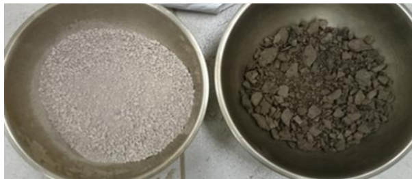
Figura 1. Pó de pedra e material fresado, respectivamente
