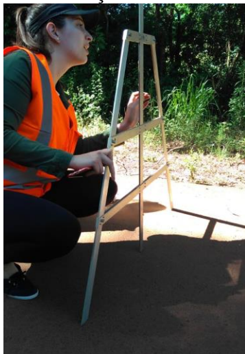
Figura 2: Execução do Ensaio de ATR
