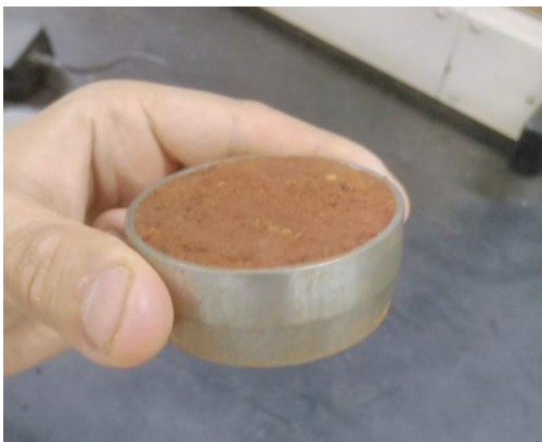
Figura 4. Anel moldado com 0,5% de Fibra para Cisalhamento Direto
