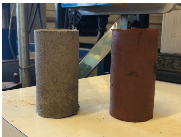
Figura 6. CP's apenas de solo-cimento (à esquerda) e com adição de resíduo de cerâmica (à direita)
