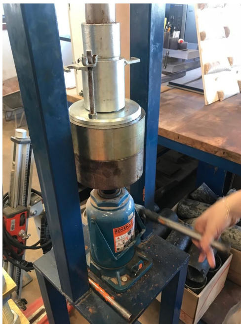
Figura 4. Compactação estática do CP
