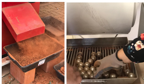
Figura 3. Processo de britagem e moagem do resíduo de cerâmica vermelha
