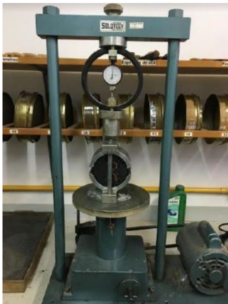
Figura 7. Equipamento para o ensaio, método Marshall.
