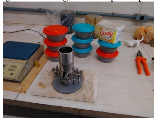
Figura 2. Moldagem dos corpos de prova
