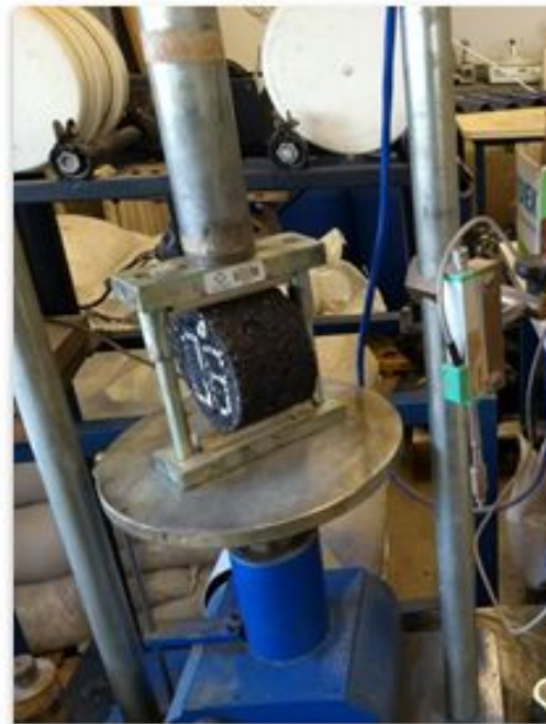
Figura 3. Posicionamento do corpo de prova na prensa metálica.
