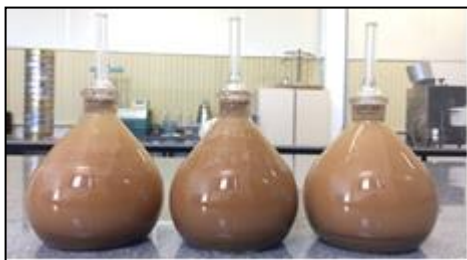
Figura 5 - Conjunto picnômetro + solo + água destilada.
