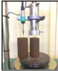
Figura 7 - Posicionamento do corpo de prova na prensa automática.
