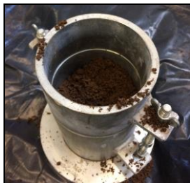
Figura 6 - Cilindro para a compactação Proctor normal.
