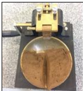
Figura 3 - Concha do aparelho de Casagrande.
