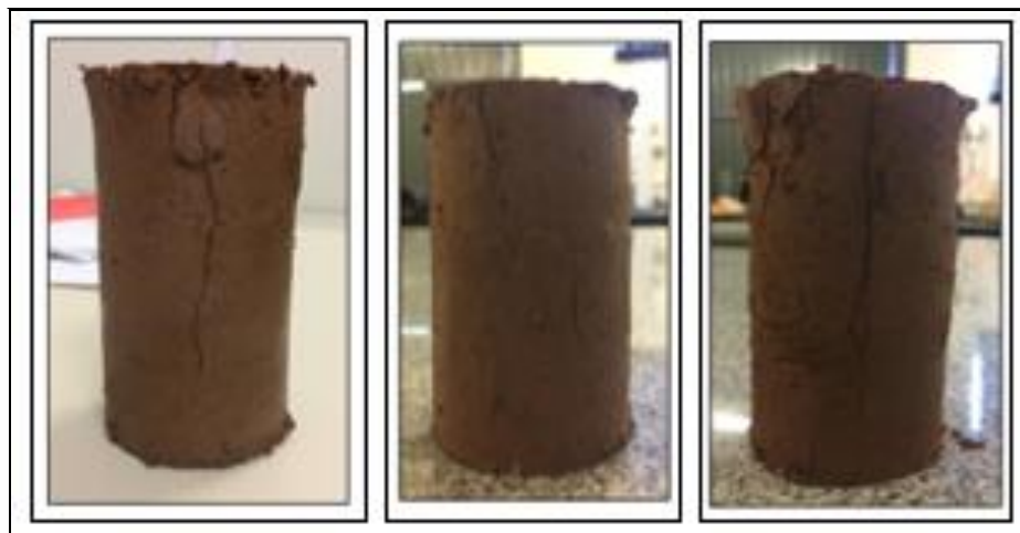
Figura 6. Corpos de prova após a ruptura
