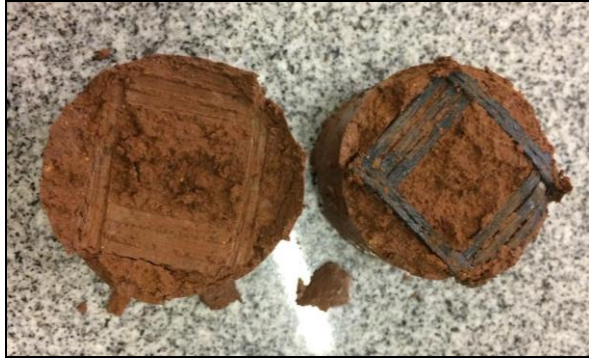
Figura 7. Abertura do corpo de prova entre as camadas
