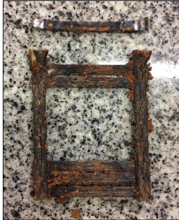
Figura 8. Ruptura da geogrelha na segunda amostra com uma camada de geogrelha
