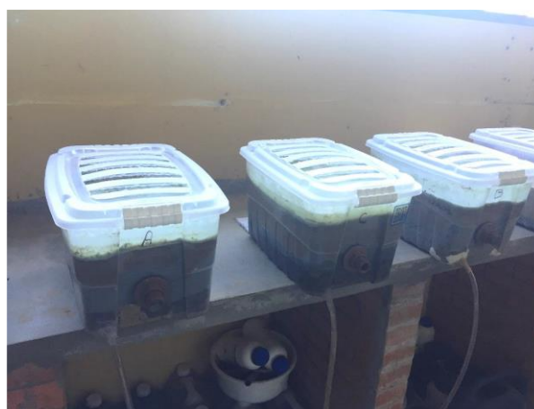
Figura 3. Sistemas implementados no experimento com os três corpos de prova que receberam o tratamento biocimentante
