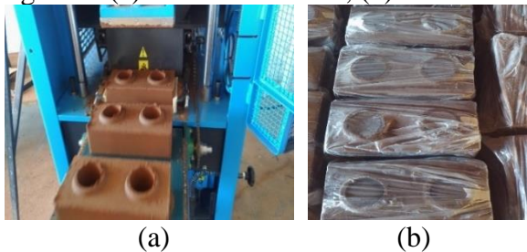
Figura 1. (a) Prensa mecânica; (b) Cura úmida
