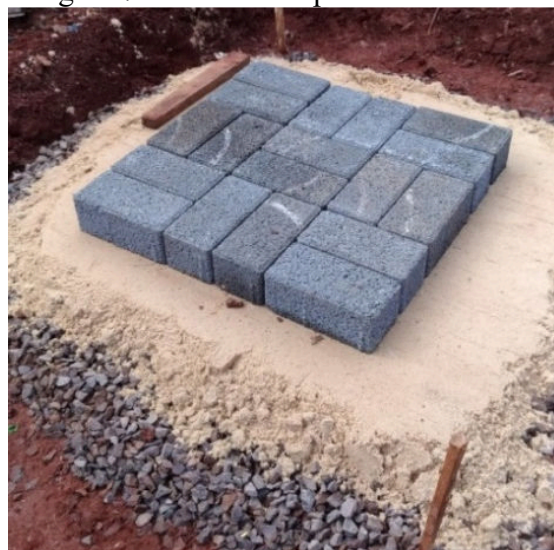
Figura 7. Estrutura do pavimento testado
