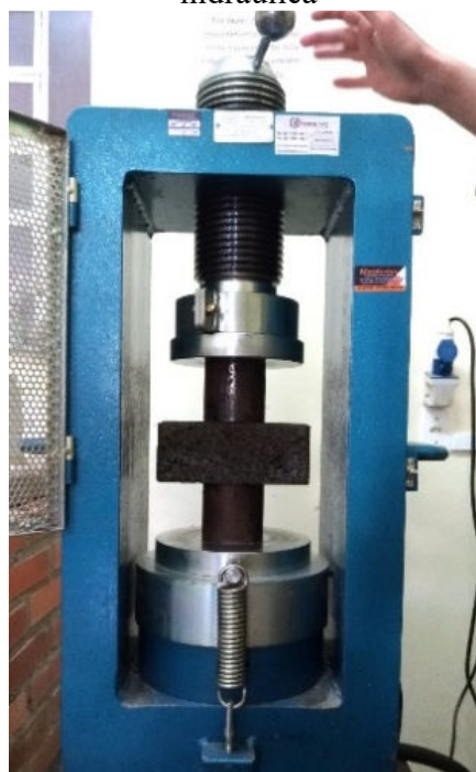
Figura 6. Paver posicionado na prensa hidráulica
